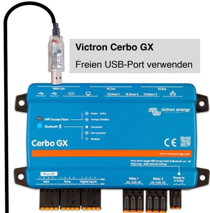
Das RS485-auf-USB-Schnittstellenkabel zwischen dem GX-Gerät und dem Energiezähler kann auf max. 100 Meter verlängert werden. Stellen Sie bitte sicher, dass die Drähte Data+ (orange) und Data- (gelb) ein verdrehtes Paar bilden!
