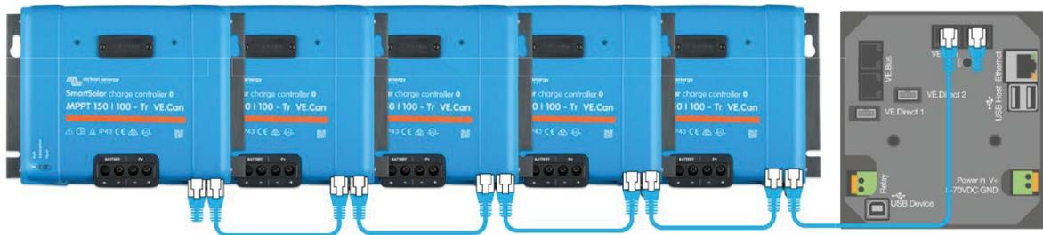
Mit VE.Can oder Bluetooth können bis zu 25 bzw. bis zu 10 Laderegler für synchrones Laden in Reihe geschaltet und mit einem Color Control GX oder einem anderen GX-Gerät verbunden werden. Jeder Regler kann individuell überwacht werden, zum Beispiel auf einem Color Control GX und auf der VRM-Website (VE.Can) oder auf einem Smartphone oder iPad (Bluetooth)
