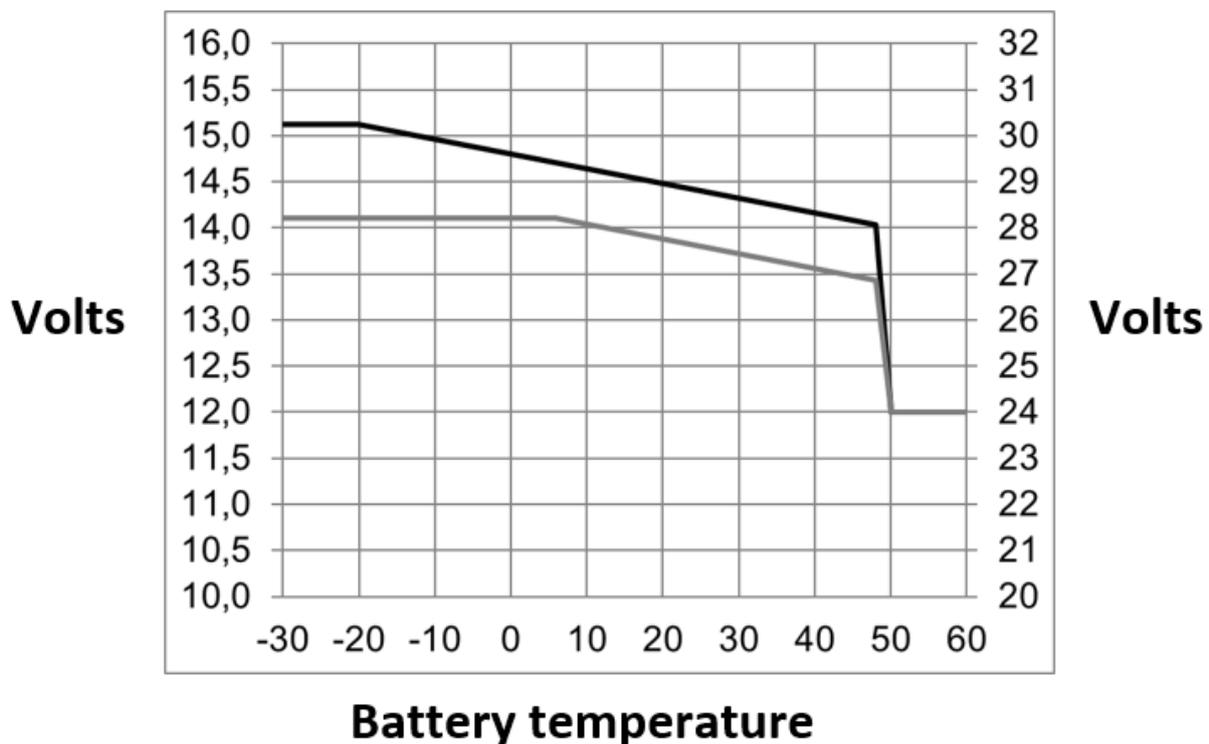
Die obige Tabelle zeigt die standardmäßigen Ausgangsspannungen für Ladeerhaltung und Konstantspannung bei 25 °C für 12- und 24 V-Batteriebanken. Für eine 48 V-Batteriebank multiplizieren Sie die 24 V-Spannungen mit 2.
