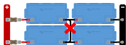
Verbinden Sie die Mittelpunkte nicht miteinander und schließen Sie nichts anderes an den Mittelpunkten an
